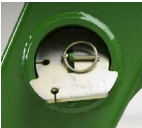
Suportes de estacionamento armazenados no tubo de torque
