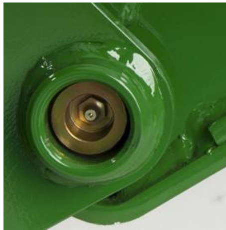
Lubrificação na extremidade do pino
