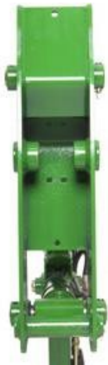
Placas de reforço no suporte de montagem
