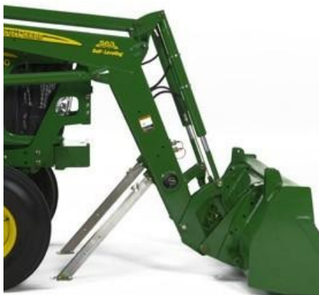
Estacionamento da carregadeira
